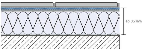
Querschnitt konventioneller Fußbodenaufbau mit Estrich
