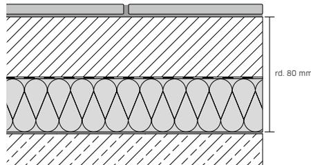
Querschnitt konventioneller Fußbodenaufbau nur mit Estrich (Wie im Wohnungsbau der 50er bis 80er Jahre typisch)
