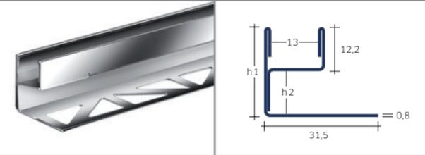
Das Glashalteprofil BLANKE AQUA-GLAS ermöglicht eine einfache und formschöne Anbringung von Glaswänden an Wand und Boden – ganz ohne Bohren und Zuschneiden von Fliesen. Im Vergleich zur herkömmlichen Vorgehensweise ist eine zerstörungsfreie und wasserdichte Verankerung gewährleistet.
